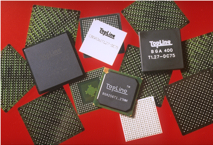
Figur: BGA-testkomponenter fra TopLine (PBGA 256, PBGA 313, CBGA 361 og PBGA 400) alle med 1.27 mm pitch.
