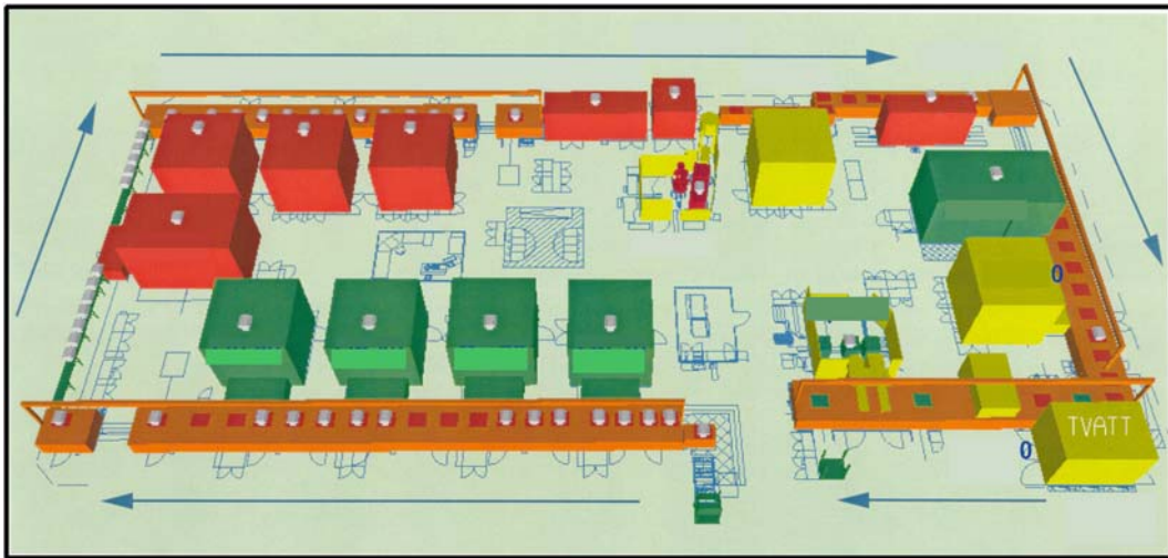
Bild 5. MONEY genererar en mycket detaljerad information angående driften i D16-linjen, och de störningar som uppstår. Genom att utnyttja denna för simulering fås en mycket noggrann bild av hur avsnittet i stort fungerar, och var flaskhalsar uppstår. Dessutom kan man studera på förhand hur förändringar i störningsbilden påverkar helheten, med hög träffsäkerhet. /Lunds Tekniska Högskola/
